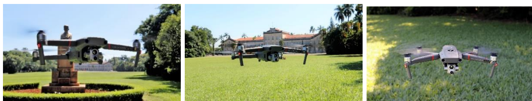
Figura 12 – Drone Mavic II Enterprise com câmera termográfica (luz infravermelha)
