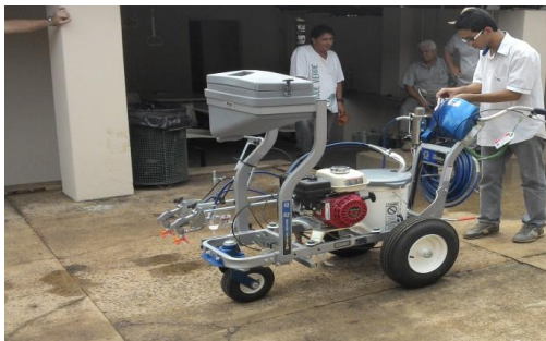
Figura 16 - Máquina de sinalização viária
