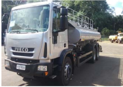
Figura 26- Caminhão IVECO, linha Premium 2016, equipado com tanque e canhão para combate a incêndios
