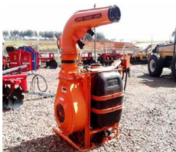
Figura 29 - Pulverizador Jacto, modelo Jatão 600, para aplicação de carrapaticida
